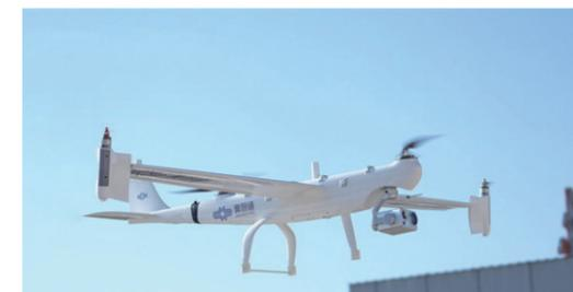
集团公司形成多层次应急融合通信方案，利用卫星通信、无线电波等技术，积极推进应急通信指挥车、无人机应急通信系统等设施设备配备，搭建应急通信网络平台，解决全灾种无通信情况下的应急通信难题，为山区偏远道路、隧道等救援现场提供稳定可靠的通信保障。
